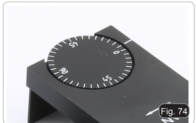
6. Ruotare il polarizzatore alla base del microscopio per ottenere il massimo oscuramento agli oculari.
