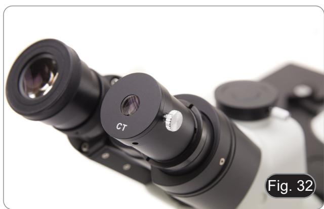
4. Con el CT, enfóquese en la imagen de anillo de fase del condensador (claro) ① y el objetivo (oscuro) ②. Si la imagen del anillo claro no es nítida, ajuste el CT hasta que la imagen del anillo claro sea nítida. (Fig. 40)
