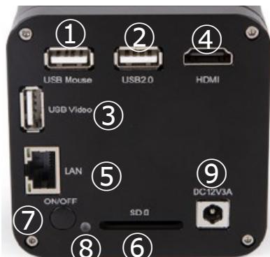
Fig. 32 - Pannello posteriore della C-HAF4K
