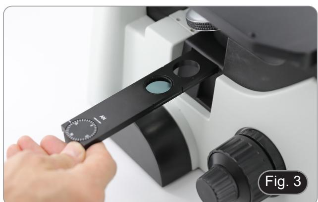
6. Insérez le filtre polarisant dans la glissière porte-filtre fournie. (Fig. 4)
