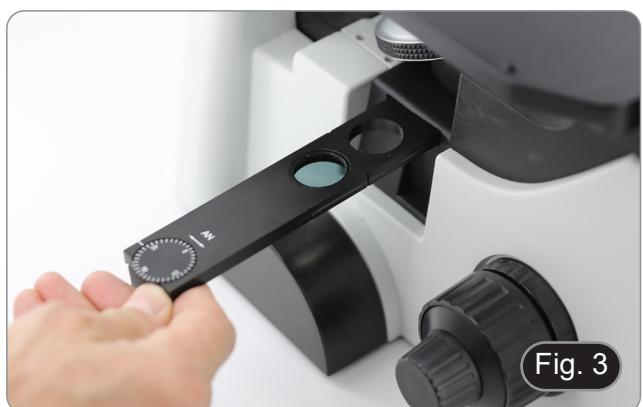
6. Setzen Sie den Polarisationsfilter in den mitgelieferten Filterschieber ein. (Fig. 4)
