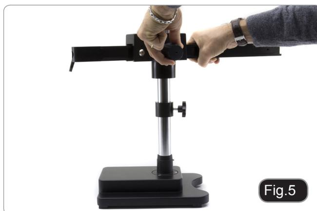
5. Installare il supporto della testa. Il supporto può essere montato in vari modi in funzione dell'utilizzo specifico.
