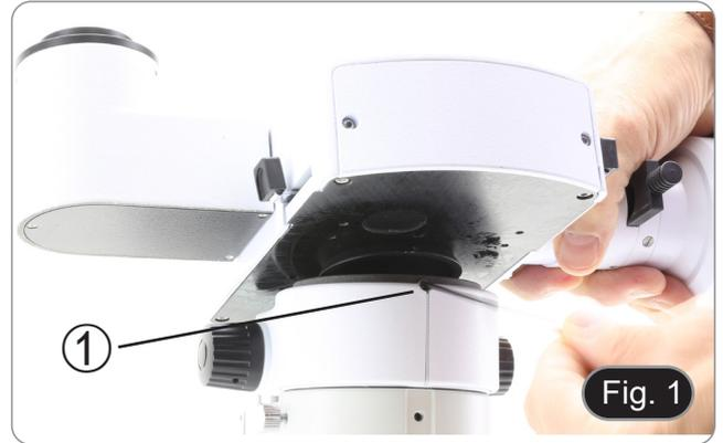
3. Allentare le due viti di fissaggio sull'attacco del corpo lampada e rimuovere il tappo di protezione.
