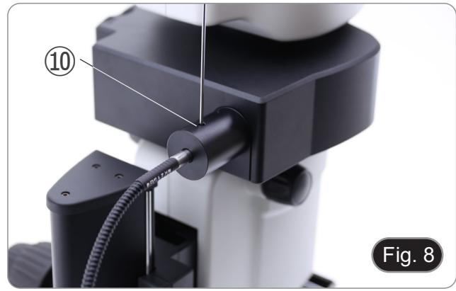
16. Insérer l'autre extrémité de la guide de lumière dans la source lumineuse. (Fig. 9)
