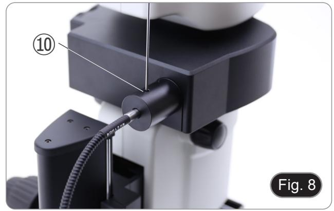
16. Insertar el otro extremo de la guía de luz en la fuente de luz.
